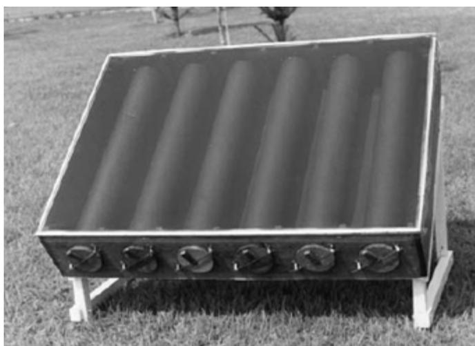
Figura 11.1 - Coletor solar utilizado na desinfestação de substrato.
